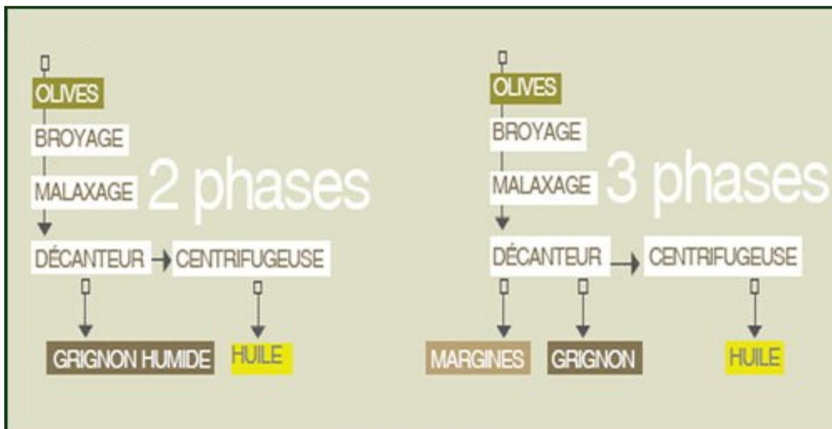
**Figure 2** : Systèmes d'extraction à 3 phases et à 2 phases (système écologique)
