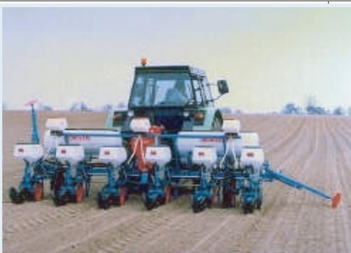
Figure 5: Exemple d'un semoir monogaine
