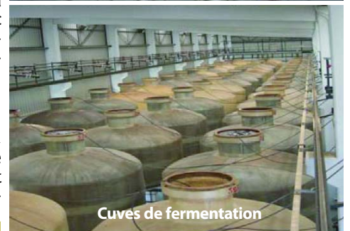
Cuves souterraines de fermentation
