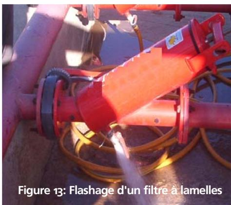
Figure 13: Flashage d'un filtre à lamelles
