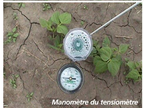
Manomètre du tensiomètre
