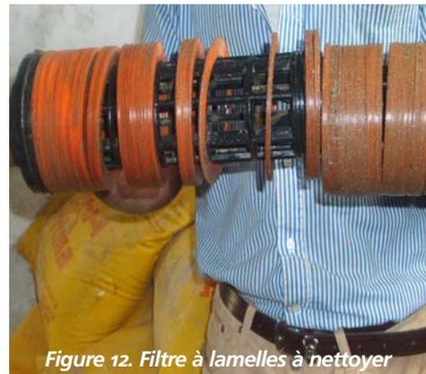
Figure 12. Filtre à lamelles à nettoyer
