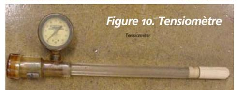
Figure 10: Tensiomètre
