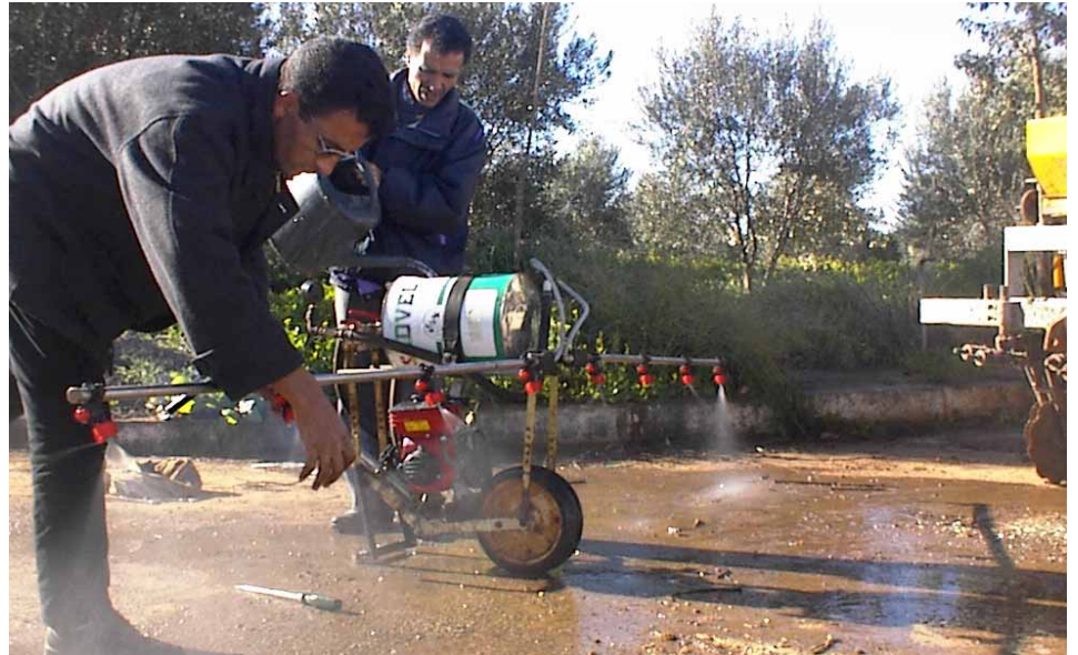
Photo 3: Test du circuit hydraulique de pulvérisateur (prototype n°1)
