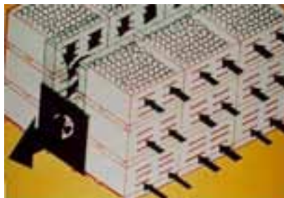
Photo 70 : Diagramme du flux de l'air dans un système de refroidissement à air forcé.
